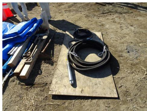
写真 1 実験で使用した小型の地中起振源（バイブレータ）
