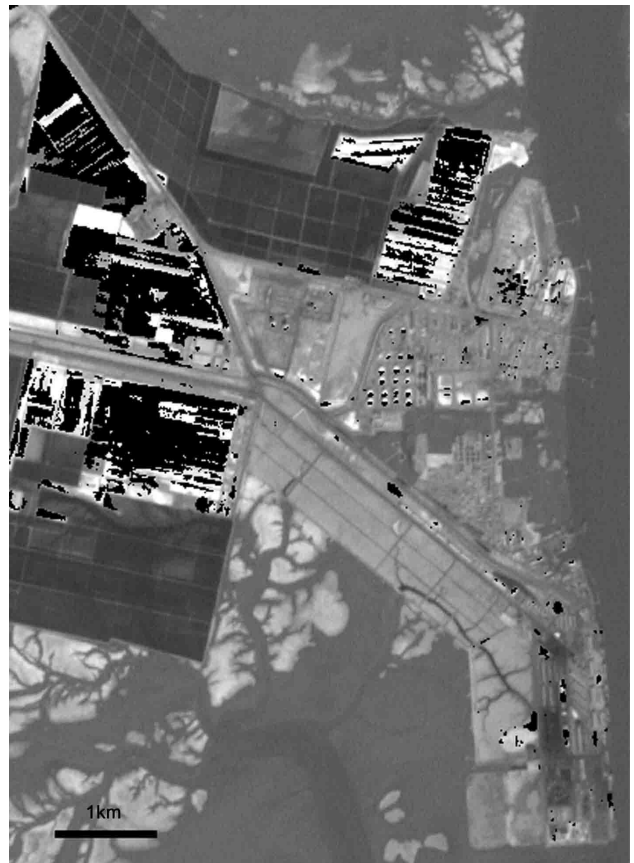
図 2(d) LANDSAT 衛星画像から推定された Kandla Port の建物被害地域 5)
