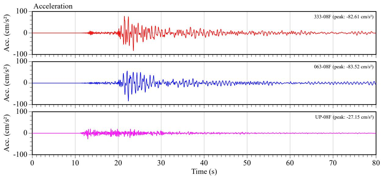
図 2.2 千葉県庁本庁舎 8 階(08F)の加速度波形
