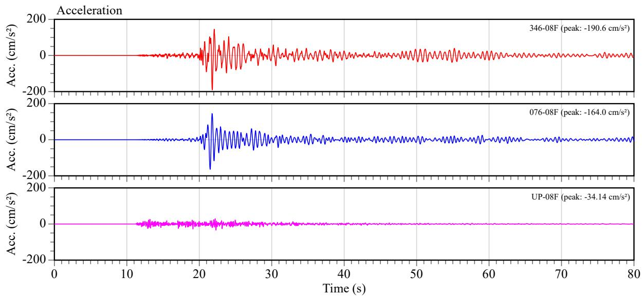
図 3.2 千葉第 2 地方合同庁舎 8 階(08F)の加速度波形
